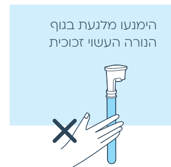
3. אחזו היטב בראש נורת ה-UV משני צדדיו ומשכו בעדינות את הנורה בקו ישר כלפי מעלה ומחוץ לבר המים.
